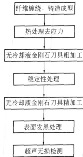
图2 铝基复合材料加工工艺流程图
